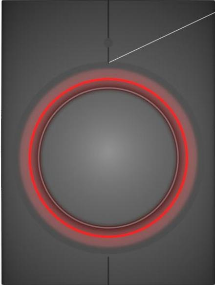
mit wiederholtem drücken schaltet man das licht aus. die zuletzt benutzte farbe wird in einem lichtkranz der den drehknopf umgibt, angezeigt.
